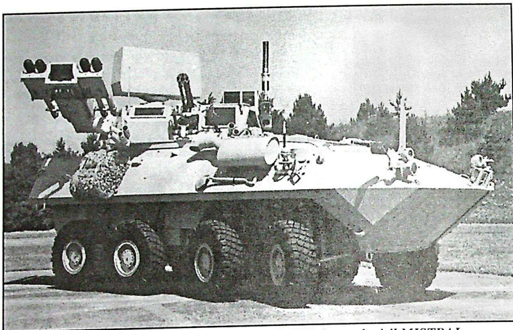
El BLAZER, sistema cañón/misil sobre un LAV 8x8 con el misil MISTRAL.
