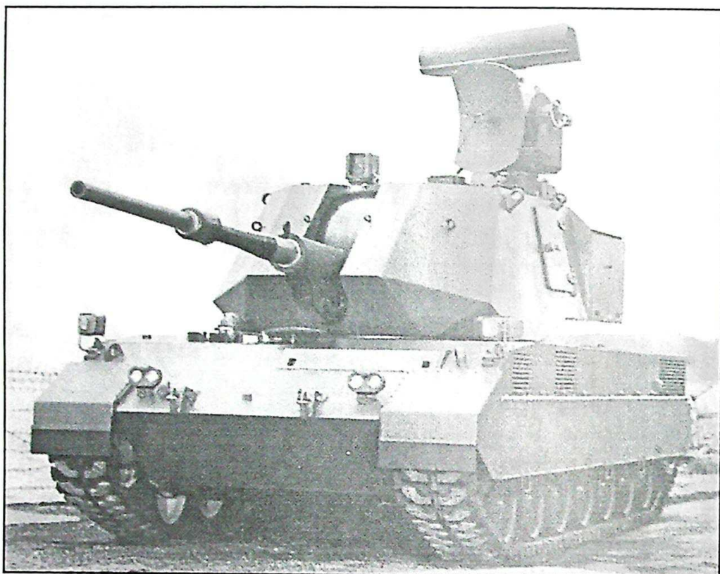
Gracias a su cañón de 76mm. el OTOMATIC aún representa una solución válida contra helicópteros armados de misiles A/T de larga distancia.
